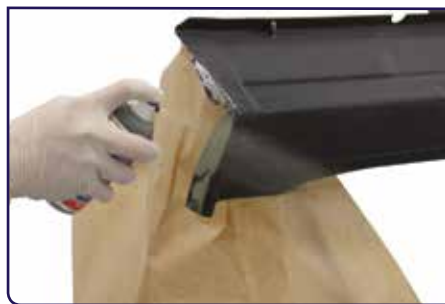
Apprêter des arrêtes Position „MIN“
