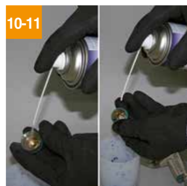
10-11 Expulser de la face frontale par pulvérisation le reste de peinture. Légèrement pencher le pistolet tête en bas.
