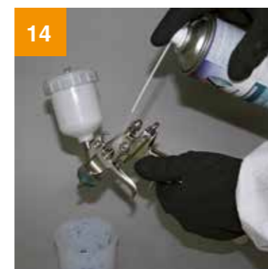
14 Nettoyer l'extérieur du pistolet peinture.
