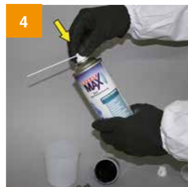
4 Installer d'une légère rotation le diffuseur lancette.
