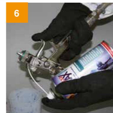
6 Retourner le pistolet et expulser par pulvérisation le reste de peinture (Laisser l'arrivée d'air au minimum).
