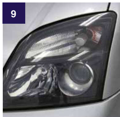
NACHHER Scheinwerferscheibe wieder klar Eintrübung und Vergilbung entfernt, Scheibe hochwertig, dauerhaft versiegelt
