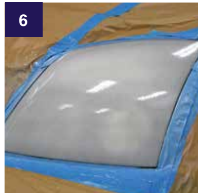
PRIMER APPLIZIERT Bild zeigt das Ergebnis, im nassen, milchigen, weißen Zustand
