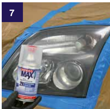
2K-KLARLACK APPLIZIEREN Nach vollständiger Trocknung des Scheinwerferprimers (noch leicht trüb) anschließend SprayMax 2K Scheinwerferklarlack auftragen
