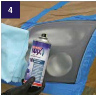
REINIGEN Geschliffene Scheibe reinigen, mit SprayMax Aqua-Silikonentferner
