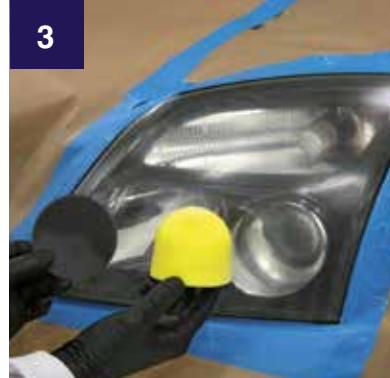
SCHLEIFEN Mit P1000 und anschließend P3000 gesamte Scheibe von Hand schleifen (empfohlen Mirka Abralon)
