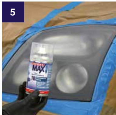
PRIMER APPLIZIEREN 1 Spritzgang bis geschlossener Film über die gesamte Scheibe entsteht
