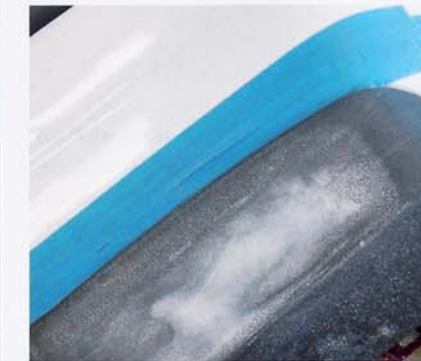
Die Oberfläche ist nun bereit für den Auftrag des 1K-Kunststofflacks.
