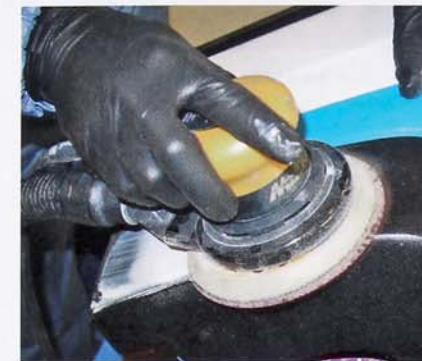
In dem Fall muss der Spachtel mit Körnung P320 angeschliffen werden.
