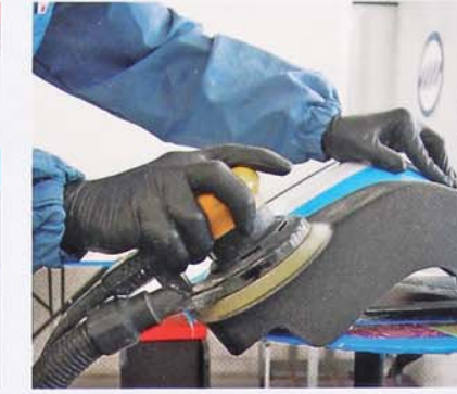
Danach werden die Kratzer ausgeschliffen.
