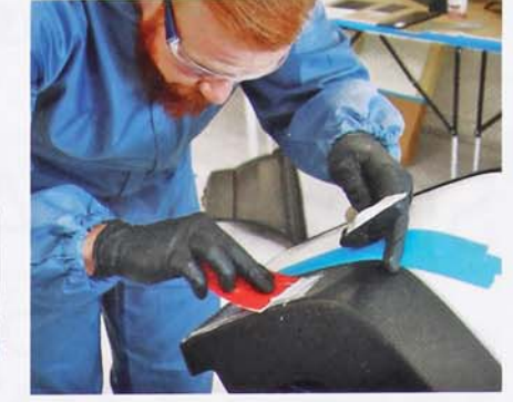
Je nach Tiefe der Kratzer kann es nötig sein, mit Kunststoffspachtel aufzufüllen.
