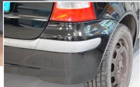
Durchgefärbte Stoßleisten vergrauen im Laufe der Zeit und sehen unschön aus.
