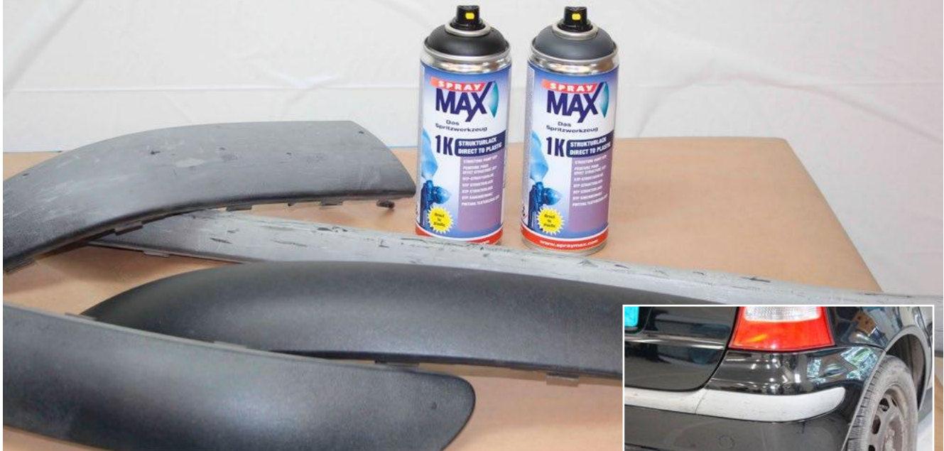
Durchgefärbte Stoßleisten vergrauen im Laufe der Zeit und sehen unschön aus.
