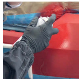
Gemessenen und ausgemischten Basislack in 2-3 Spritzgängen applizieren. Luftrocknen.
