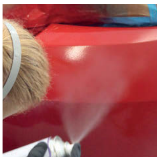
Unmittelbar nach dem UV-Klarlack den UV-Beispritzlack in den Klarlack und den Randbereich einblenden. 1 Minute ablüften.
