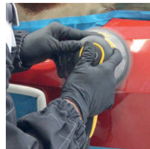
Schadstelle schleifen z.B. P320, anschließend mit Silikonentferner reinigen. Kunststoffhaftvermittler aufbringen.
