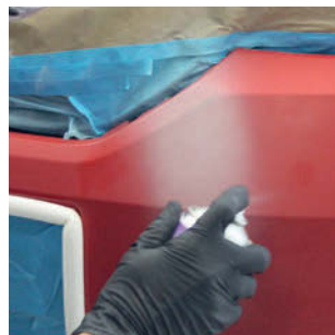
Durch die Trocknung entstandenen Klebefilm mit speziellen UV-Reiniger entfernen, Fläche schleifen, Randzonen anmattieren.
