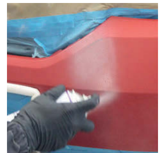
UV-Füller aufschütteln, mit ca. 1-2 Spritzgängen (40-50 µm) applizieren, anschließend ca. 1 Minute Abluftzeit.
