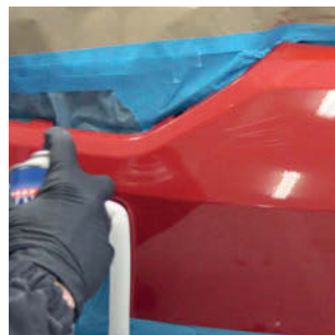
Schadstelle mit Silikonentferner reinigen. Gereinigte Fläche anschließend polieren, erneut reinigen.
