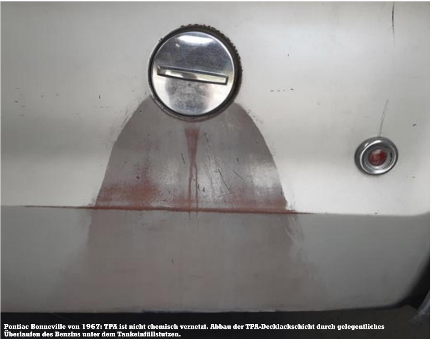
**Pontiac Bonneville von 1967: TPA ist nicht chemisch vernetzt. Abbau der TPA-Decklackschicht durch gelegentliches Überlaufen des Benzins unter dem Tankeinfüllstutzen.**
