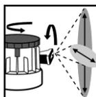
Fijar la boquilla variable a la talla o forma del area dañado.
