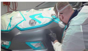
15. Después de realizar una prueba de rociado, aplique una capa base mixta a base de agua.
