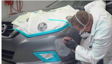
3. Lije mecánicamente el área dañada comenzando con abrasivo de grano P120 y luego P240.
