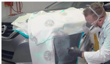
9. Con calentamiento infrarrojos: distancia de 16 pulgadas a 800 vatios / seco durante 20 minutos; alternativamente, se puede usar una pistola de calor para acelerar el proceso.
