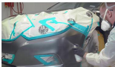
19. Después de activar 2K Clear Glamour 368-0061 y realizar un spray de prueba, aplique sobre el área de reparación pintada.
