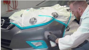
1. Lavar y secar el vehículo a mano, se inspecciona minuciosamente, luego se agrava el área dañada para eliminar cualquier resto de película y contaminantes.
