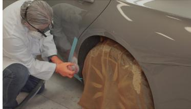
3. Poncer mécaniquement l'endroit endommagé avec le P220.
