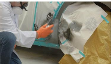
12. Passer le chiffon dépoussiéreur, faire l'essai de l'aérosol. Appliquer la couleur à solution aqueuse. Utiliser un pistolet à air pour accélérer le séchage.
