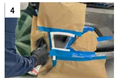
4 1K AC-Füller in 2-3 dünnen Schichten applizieren
