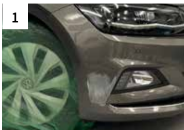
1 Schadstelle reinigen und mit P400 schleifen
