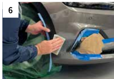
6 Schleifen per Hand mit P60
