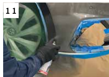
11 Weitere 1-2 Spritzgänge dazwischen immer ablüften
