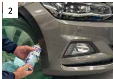
2 Reinigen mit Silikonentferner
