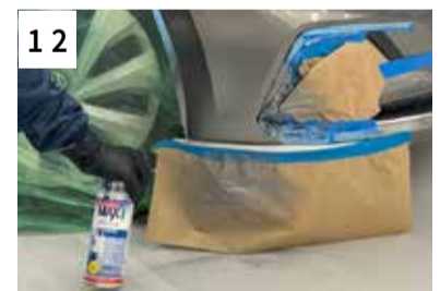
12 Nach dem Ablüften 1K Klarlack auftragen
