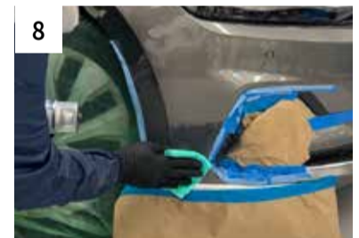
8 Für Basislack vorbereiten mit Staubbindetuch säubern
