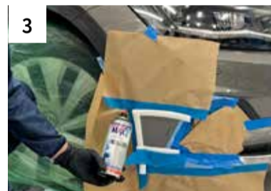
3 Sorgfältig abkleben für AC-Füller Auftrag
