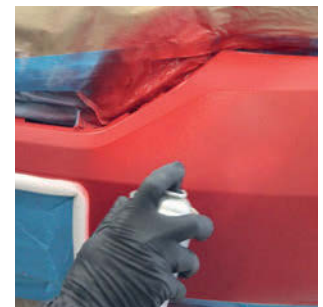
UV-Klarlack mit 1-2 Spritzgängen mit Zwischenabluft applizieren.
