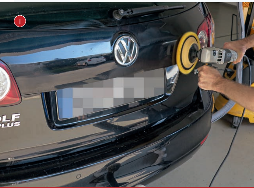
Nachdem die zu lackierende Fläche mit Silikonentferner gereinigt wurde, wird sie poliert, um Mikrokratzer zu entfernen.
