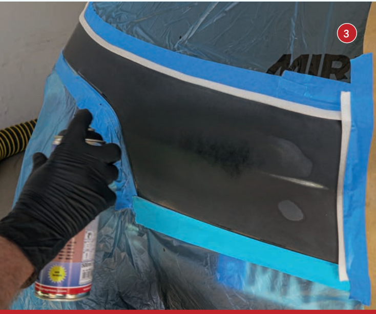
Auftragen des Füllers auf der Reparaturstelle.
