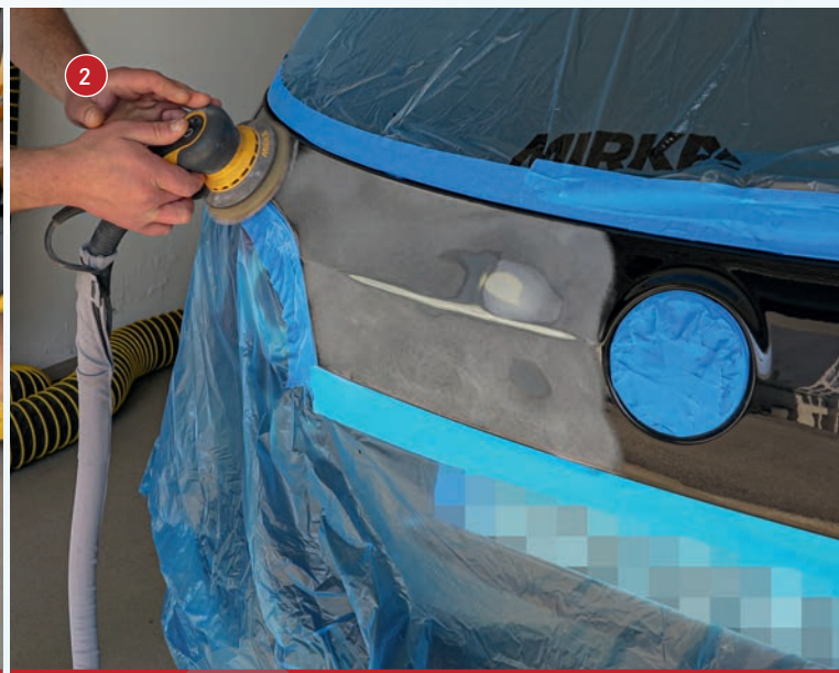
Nachdem Krafthand-Redakteur Sebastian Schuster die zu behandelnden Dellen gespachtelt und geschliffen hat, schleift er den kompletten zu lackierenden Bereich an.
