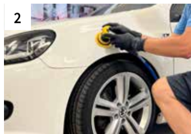
2 Zu lackierende Fläche großzügig polieren
