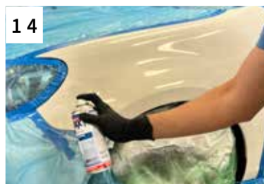
14 2K Klarlack applizieren (2 Spritz- gänge mit Zwischenablüften)
