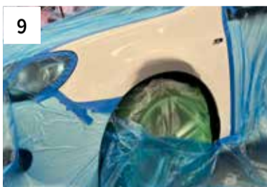
9 Ablüften (ca. 5 Min zwischen den Spritzgängen)
