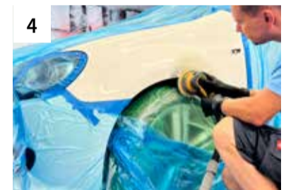
4 Schadstelle schleifen maschinell P80- P240 Randzone P320-400
