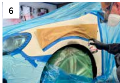
6 Mit 2K Säure-Primer grundieren (2 dünne Spritzgänge)
