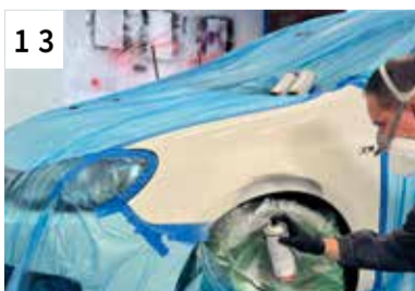
13 Basislack applizieren (je nach Deckkraft 2-3 dünne Spritzgänge)
