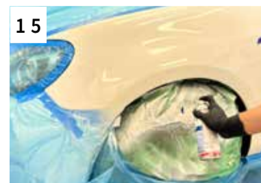
15 Auf Randzone Beispritzverdün- nung applizieren
