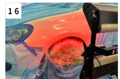
16 IR Trocknung ca. 20 Min. bei 30 - 40 cm Abstand
