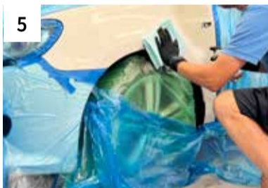
5 Reinigen mit 1K Silikon- Entferner
