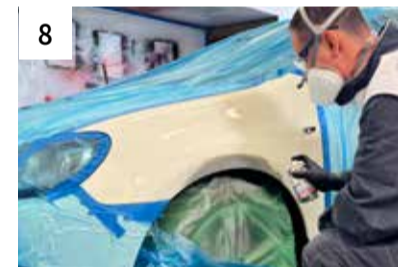
8 Grundieren mit 2K Acryl- Schleiffüller (2-3 Spritzgänge)
