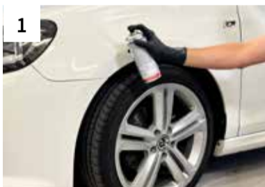
1 Schadstelle reinigen mit 1K Silikon-Entferner
