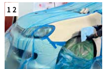
12 Reinigen mit 1K Aqua-Silikon- Entferner
