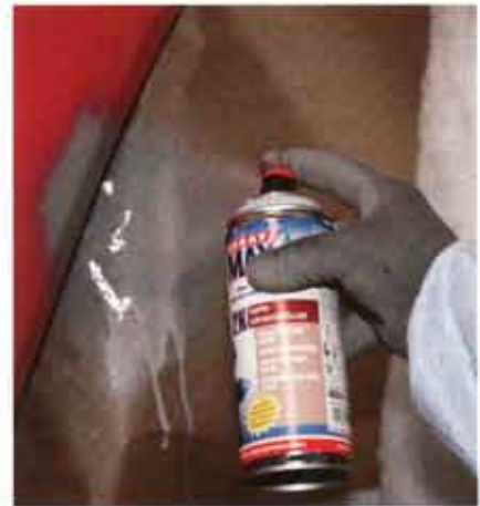
Bei Füller, Primer und Kunststoffhaftgrund ist „Dosenware“ mittlerweile weit verbreitet.
