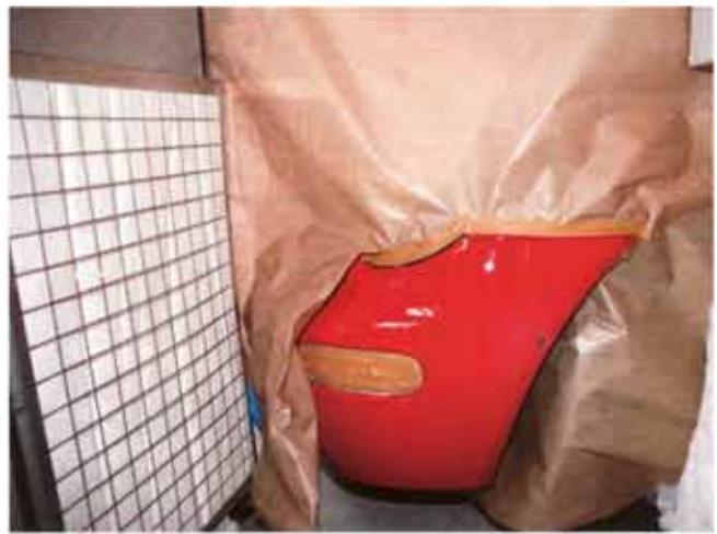
Eine Bahn Abdeckpapier bildet den vorderen Rand der mobilen „Spritzbox“. Lacknebel gelangt damit exakt dorthin, wo er gebraucht wird.
