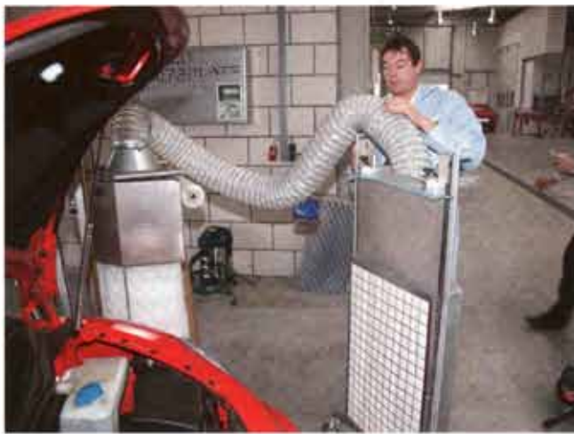
Das mobile Absaugsystem schafft Unabhängigkeit. So kann, je nach Reparaturumfang, überall in der Werkstatt gearbeitet werden.
