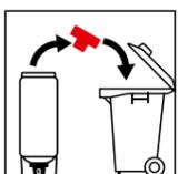
Damit sofort ersichtlich ist, dass der Härter ausgelöst worden ist, sollte der rote Knopf nach dem Auslöseprozess nicht in die Dosenkappe zurück gesteckt werden, sondern gleich entsorgt werden.
