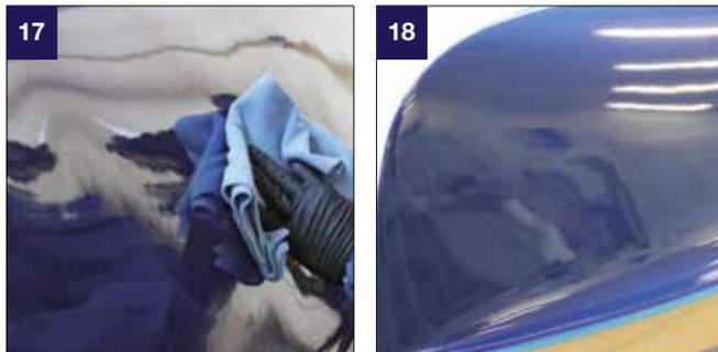
17 Passer un chiffon propre sur la surface appliqué avec l'aérosol Finish Control et vérifier visuellement la teinte
