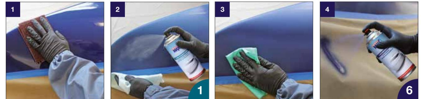
1 Si nécessaire appliquer un tampon rugueux sur la surface sous la ligne de flottaison
